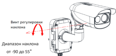
Рисунок 2-24 Регулировка оси наклона
