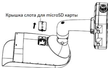
Рисунок 2-7 Демонтаж крышки слота для карты памяти
