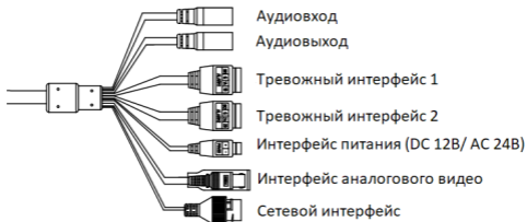
Рисунок 1-5 Описание кабелей камеры II типа
