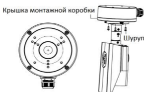
Рисунок 2-4 Установка камеры с монтажной коробкой
